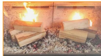
Lors du test à la norme EN 13229, l'insert a été utilisé comme indiqué sur la photo:
