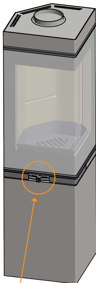
Commandes d'air d'allumage et d'air de chauffage
